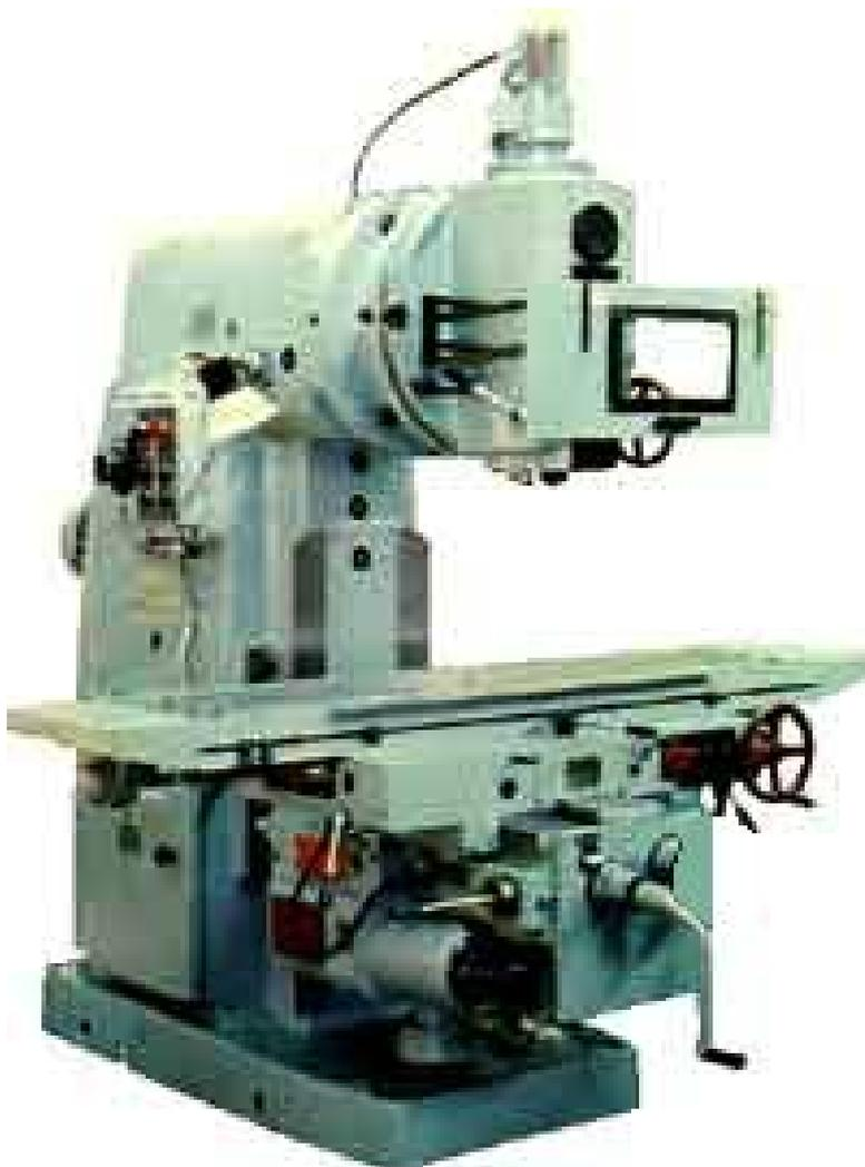
Рис. 1. Станок фрезерный консольный модели ВМ127М
